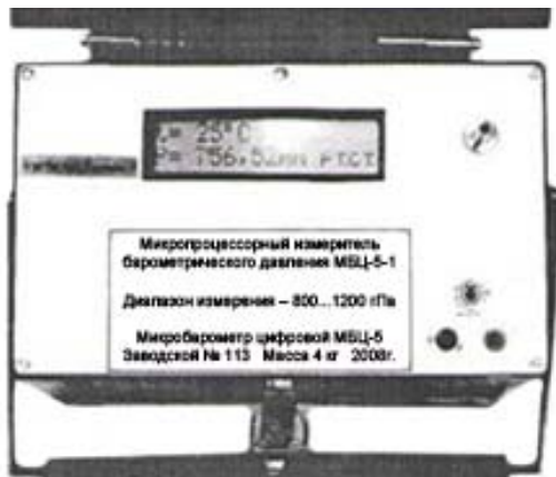
Рис. 7 - Зовнішній вигляд мікропроцесорного вимірювача барометричного тиску типу МБЦ-5
