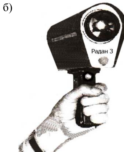
Рис. 8 – Прибори для безконтактного вимірювання температури: а) пірометр «Квант-РТ»; б) пірометр «Радан».
