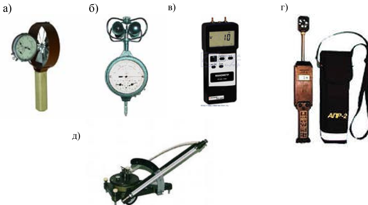
Рис.6 – Прилади для вимірювання швидкості вентиляційного потоку: а - крильчастий анемометр, б - чашковий анемометр; в - цифровий електронний анемометр; г - диференціальний анемометр, д - мікроманометра типу ММН-240
