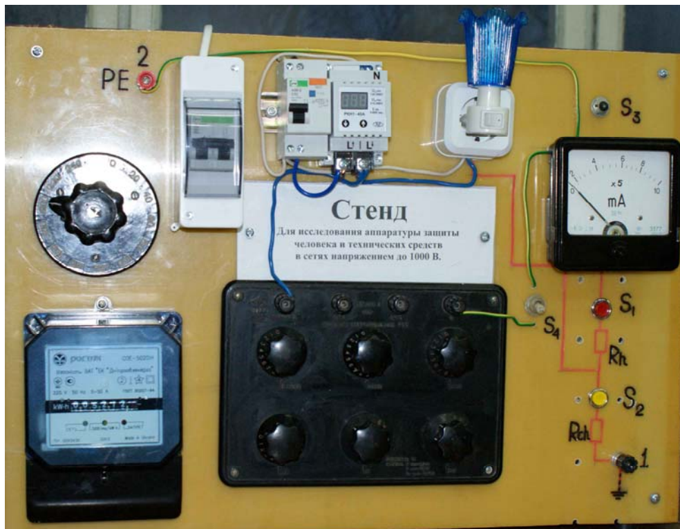
Рис. 7.1. Стенд для досліджень ПЗВ-Д та реле РКН
