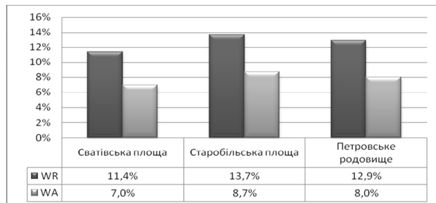
Рисунок 3.56 – Діаграма середніх показників W_t^r та W^a пласта m_3 по площах Старобільського вугленосного району
