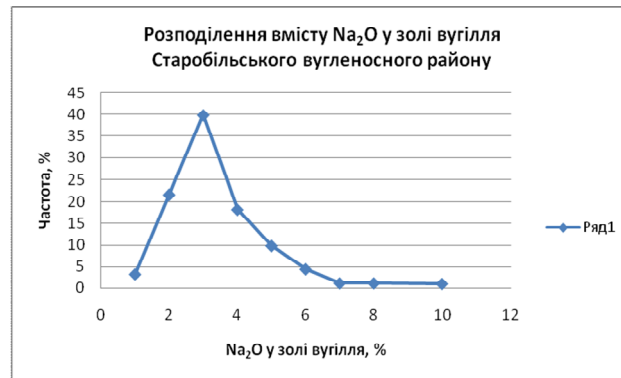
Рисунок 4.9 – Розподілення вмісту Na 2 O в золі вугілля Старобільського вугленосного району
