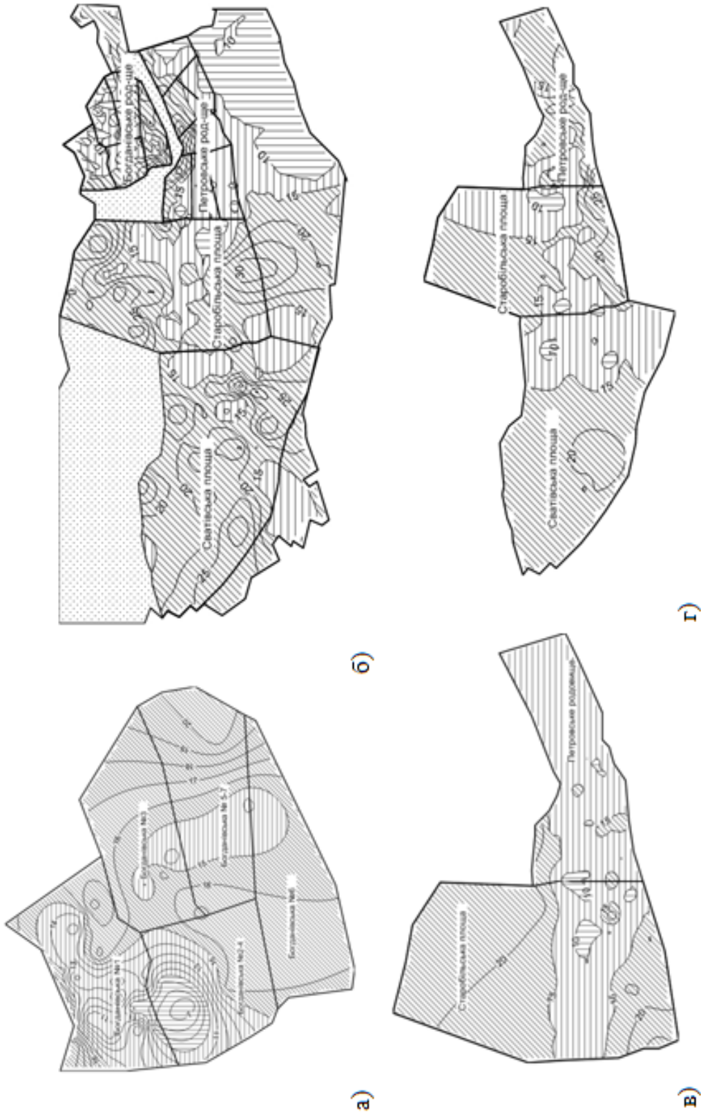
Рисунок 4.6 – Карти зольності за пластами h_8 (а), k_2 (б), l_7 (в), m_3 (г) з виділенням зон поширення вугілля за групами придатності для гідрогенізації
