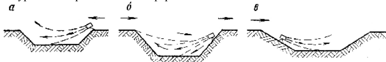
Рис. 7.20. Схемы вентиляции карьеров вентиляторной установкой.
