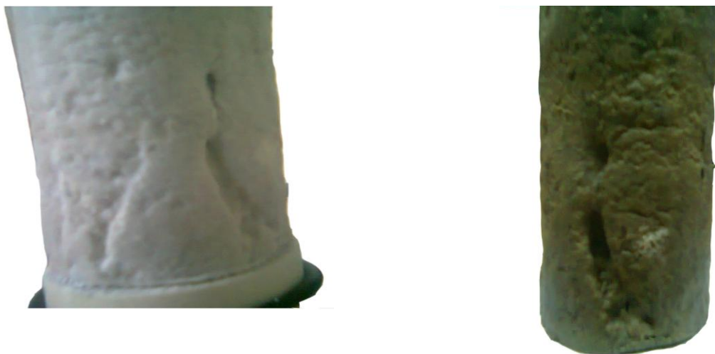
Рисунок 2.8 – Эрозионные каналы в образцах лессовых пород
