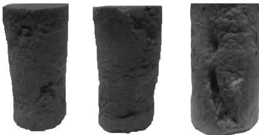
Рисунок 2.13 – Эрозионные нарушения в образцах лессовых пород для схемы фильтрации параллельно напластованию
