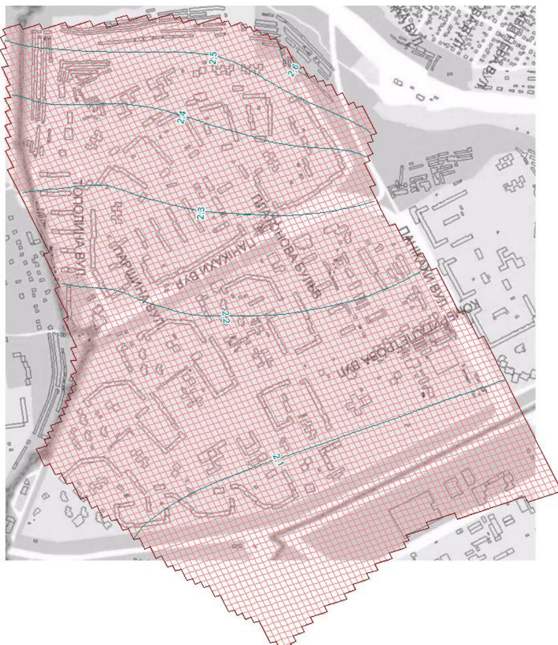
Рисунок 4.7 – Подъем уровня подземных вод (м) четвертичного водоносного горизонта на период до 2022 г. (вариант 2)
