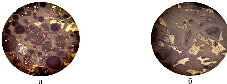
Рис. 3. Магнітний (а) і немагнітний (б) продукти в відбитому світлі; скріплений поліруваний шліф; ув.  $120^{\times}$
