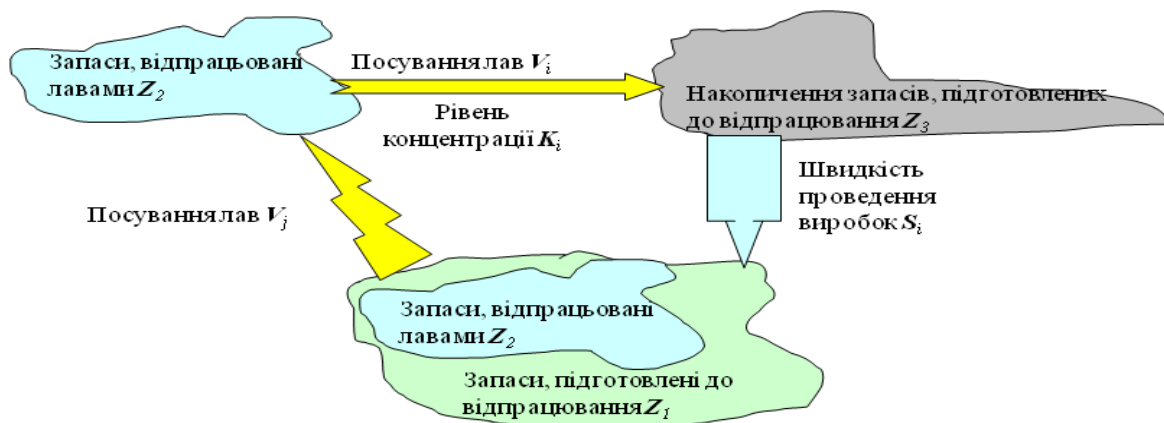
Рис. 3. Схема руху запасів при змінних швидкостях посування лав
