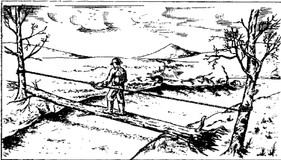
Рис. 3.17. Тимчасовий мостовий перехід
