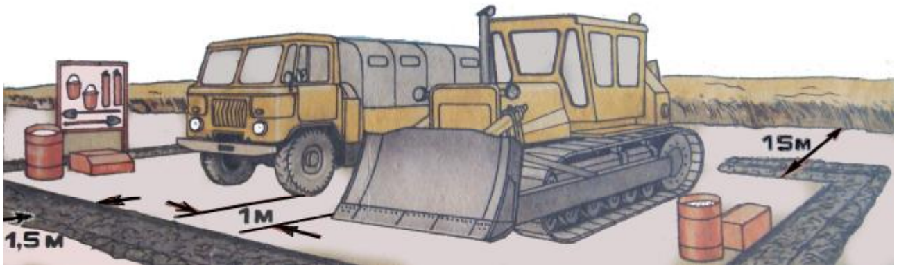
Рис. 5.6. Протипожежне обладнання стоянки транспорту
