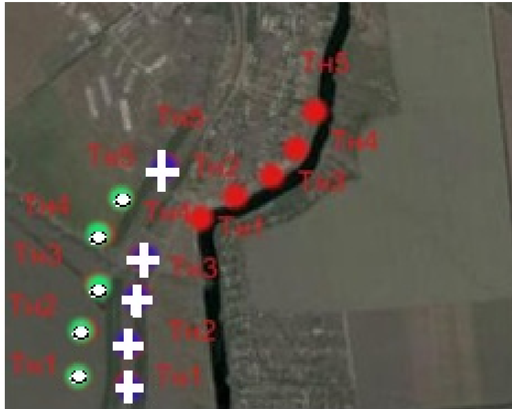
Рисунок 1.19 – Розташування прямого (світлі хрестики) і зміщеного зворотного (світлі точки) ходів маршруту уздовж лівого берега р. Мокра Сура
