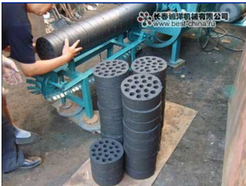
Рисунок 1.10 – Мініустановка для виробництва стільникових вугільних брикетів
