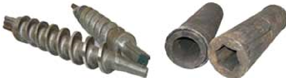
Рисунок 1.6 – Шнек і форма брикетувальника
