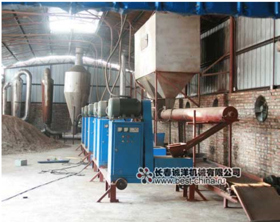
Рисунок 1.1 – Автоматична лінія продуктивністю 1500 тонн на рік
