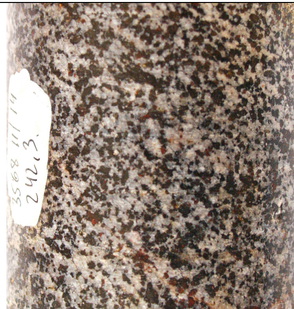
Малюнок 3.10 – Мезократовий кальцифір масивної текстури зі слабо вираженою лінійністю темнокольорових мінералів. Капітанівський масив, скважина 3568, ствол 2, глибина 242,3 м.
