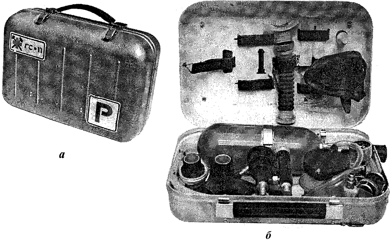
Рис. 5.11. Апарат для відновлення дихання потерпілих (реанімації) "Горноспасатель-11Р"
