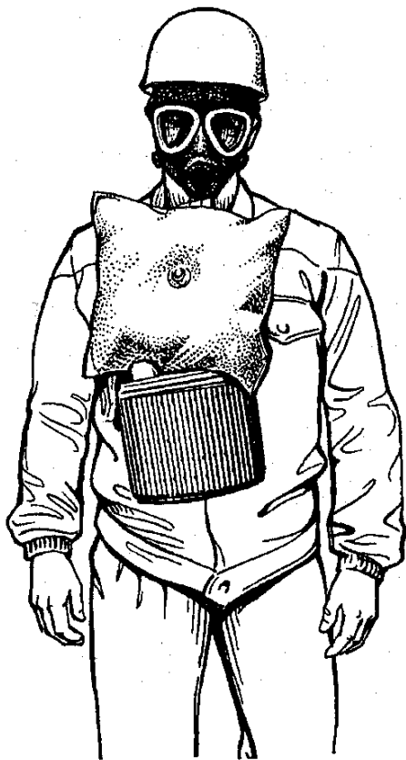
Рис. 5.10. Універсальний ізолюючий протигаз УП-1
