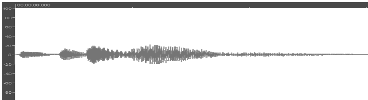
Рис. 2. Восстановленный сигнал при размере ранговой последовательности r=6 . Коэффициент сжатия: 2. СКО: 0.238.
