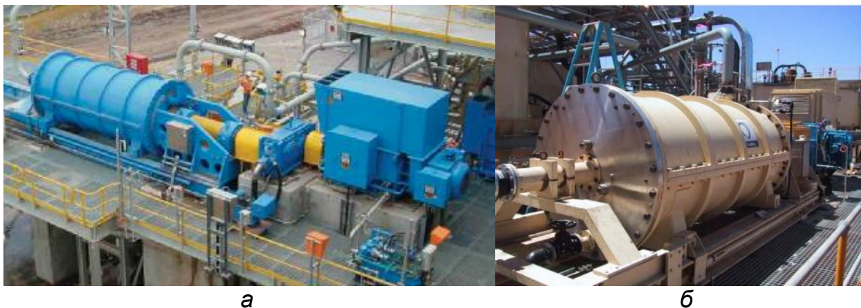
Рис. 4.14. Расположение мельницы IsaMill M3000 (а) и IsaMill M10000 (б) в производственных условиях (б)
