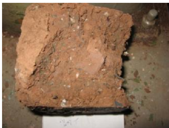
Рис. 3.22. Фотографии излома поверхности разрушенных образцов твердеющей закладки при разной площади удельной поверхности шлака и отходов флюса: а – при S_{y\delta}=6600 \text{ см}^2/\text{г} ; б – при S_{y\delta}=4300 \text{ см}^2/\text{г} ; в – при S_{y\delta}=2800 \text{ см}^2/\text{г}
