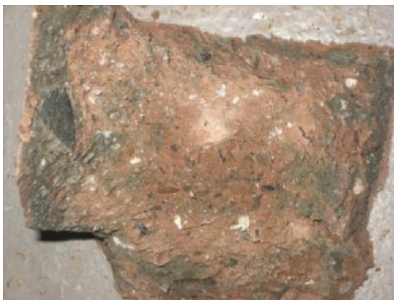
Рис. 2.2. Поверхности излома образца твердеющей закладки
