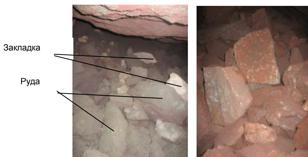
Рис. 1.3. Разубоживание руды закладочным материалом при погрузке самоходной техникой (гор. 825 м)
