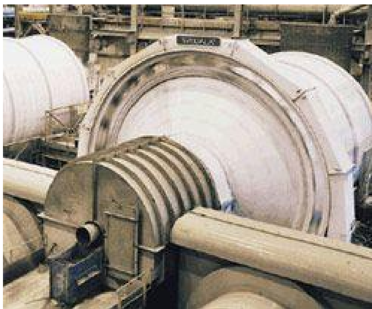
Рис. 4.8. Общий вид шаровой мельницы модели VM в производстве
