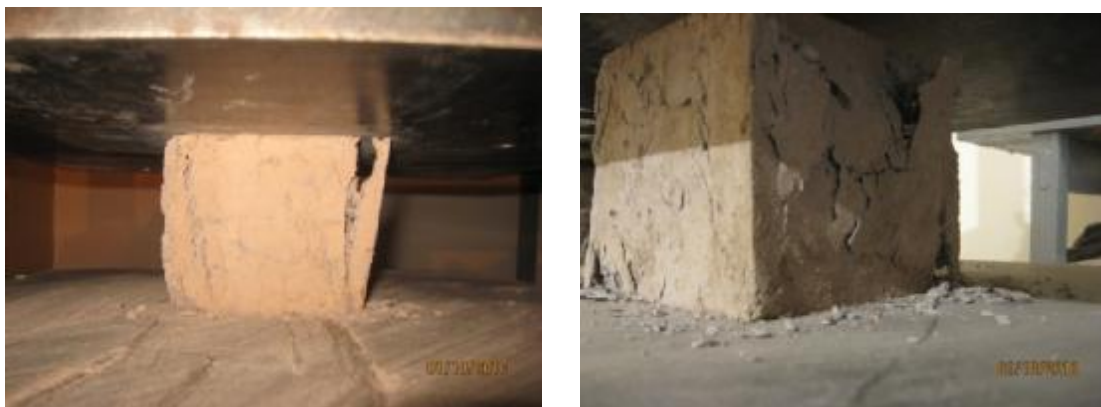
Рис. 3.11. Испытания образцов твердеющей закладки
