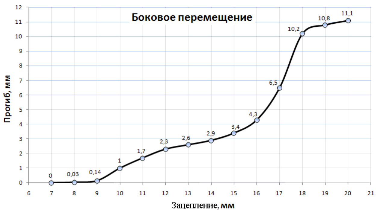
Рис. 4.46. График зависимости бокового прогиба проводника в состоянии соскальзывания от первоначального зацепления при силе из графика рис. 4.44 для каждой величины перекрытия.
