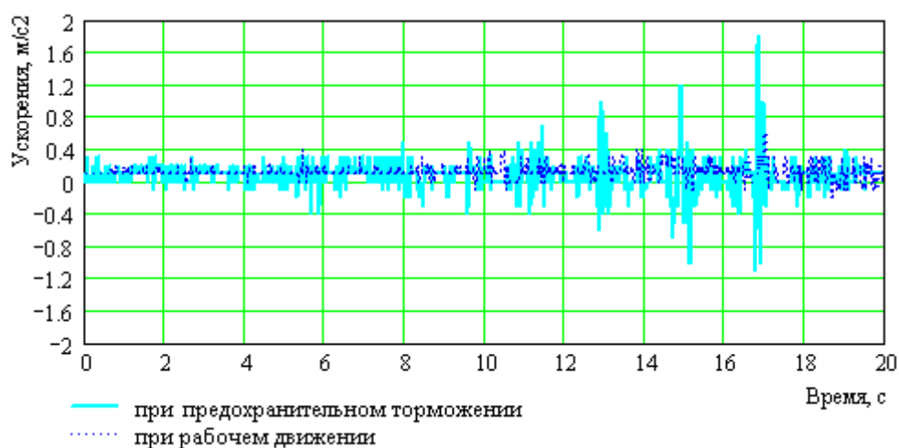
Рис. 3.11. Осциллограмма горизонтальных ускорений при срабатывании предохранительного тормоза и при рабочем режиме движения контрвеса
