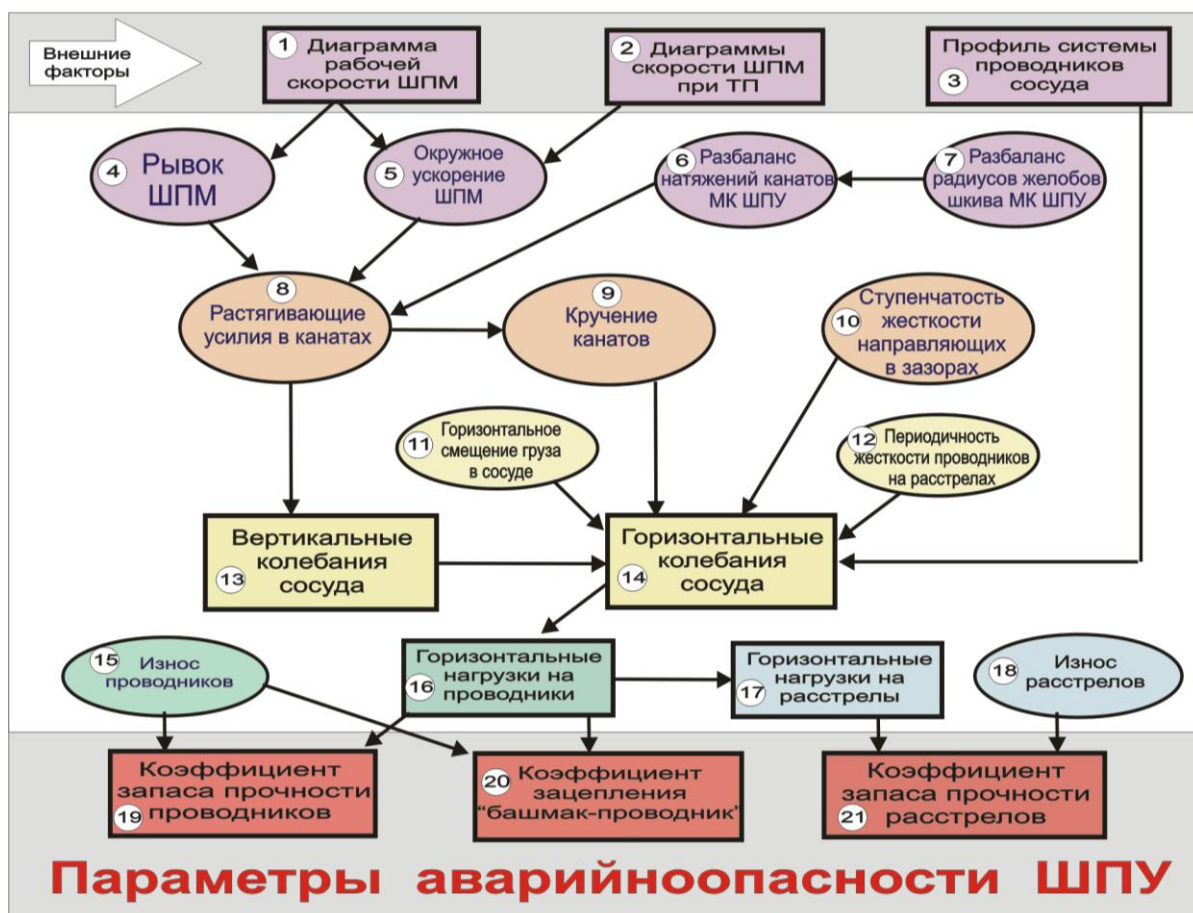
Рис. 4.1. Схема (граф) влияния технических параметров ШПУ на параметры аварийноопасности системы «сосуд-армировка»
