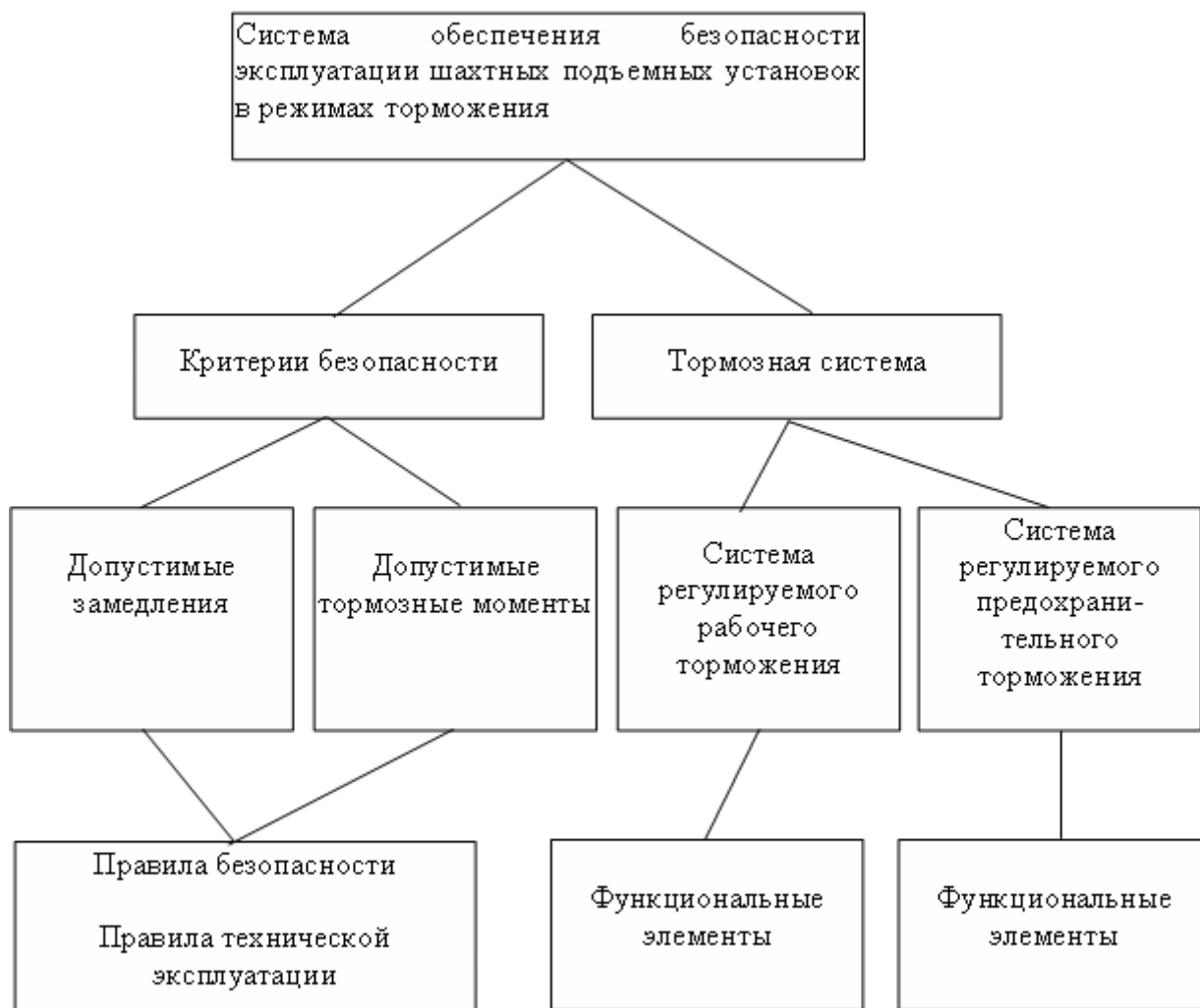
Рис. 2.10. Структурная схема системы обеспечения безопасности эксплуатации шахтных подъемных установок в режимах торможения
