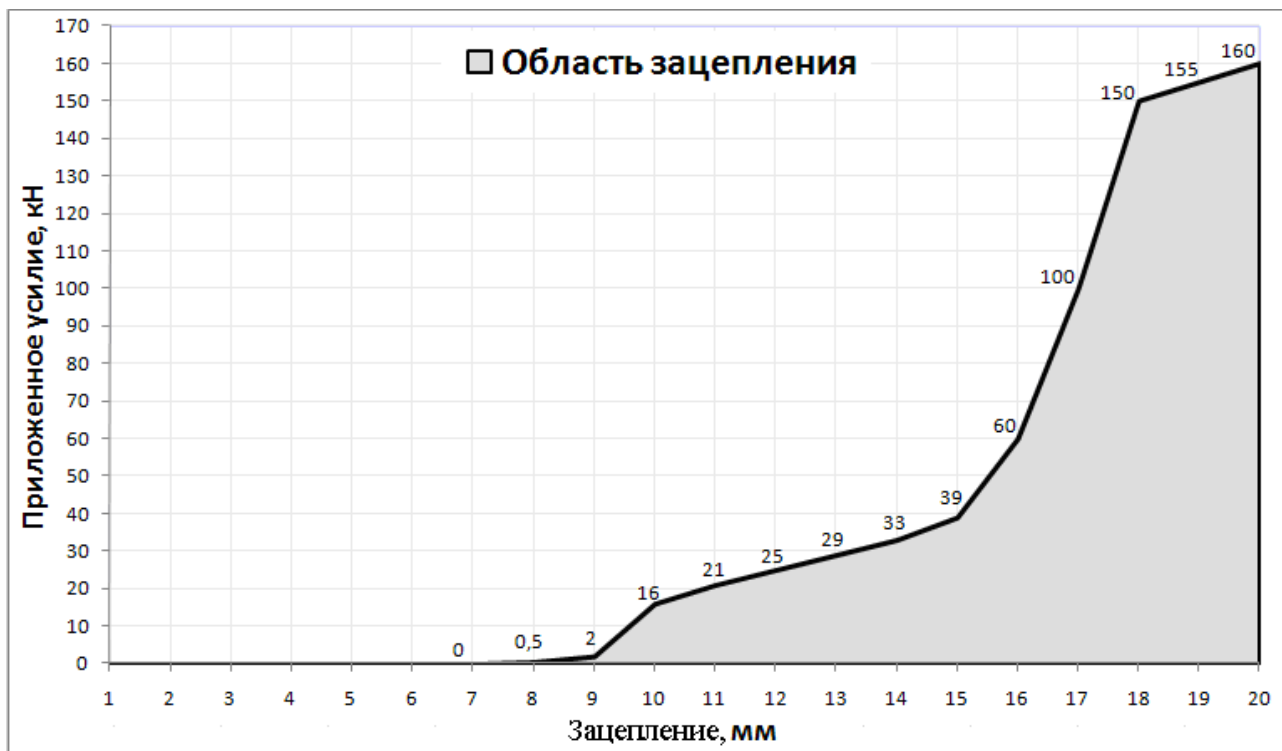
Рис. 4.44. График, определяющий зависимость между боковой нагрузкой и минимально допустимым зацеплением башмаком проводника по критерию выхода из зацепления
