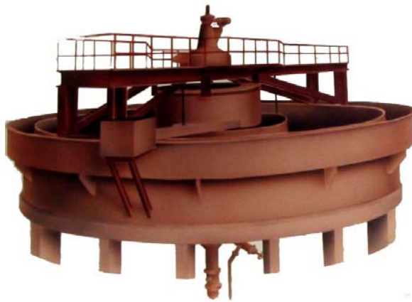
Рис. 5.9. Отстойники для осветления вод оборотного водоснабжения: а) – вертикальный отстойник; б) – горизонтальный отстойник
