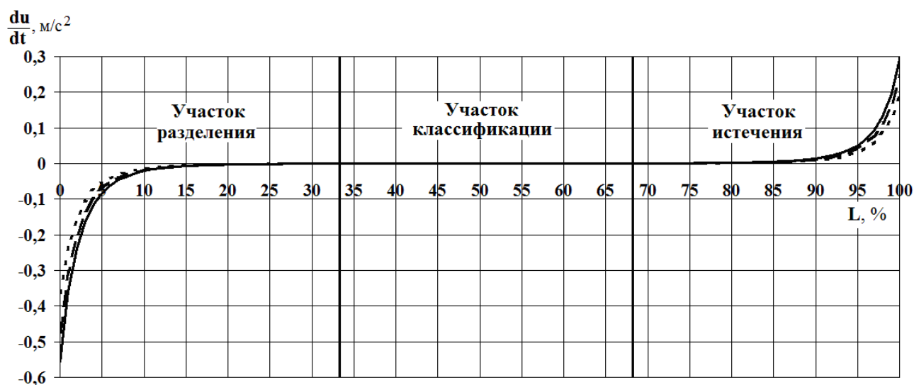
Рис. 2.5. Ускорение потока в классификаторе гидравлическом горизонтальном: — — — по координате x ; — — — по координате y ; · · · · · по координате z .
