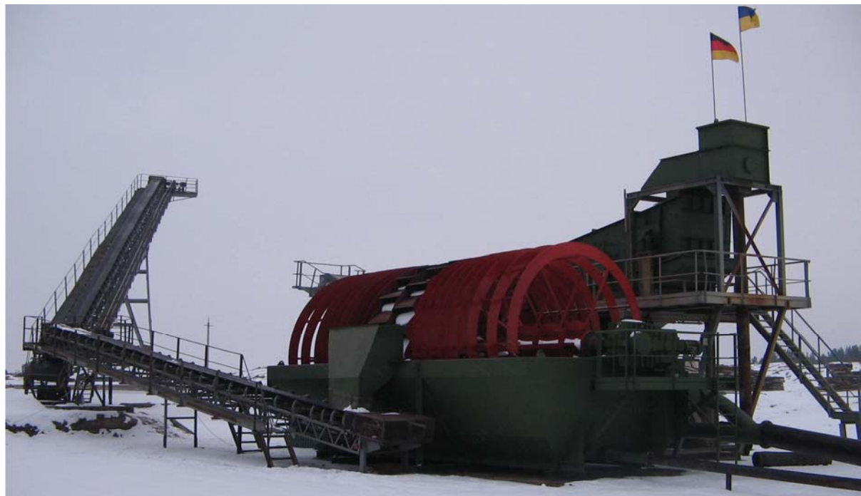
Рис.1.3. Барабанная (корытная) мойка для переработки зернистых полезных ископаемых, добываемых гидромеханизированным способом
