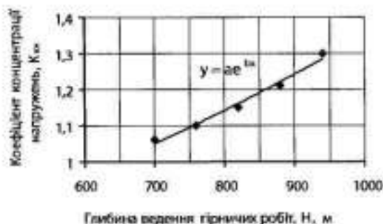
Рис. 5. Графік залежності коефіцієнта концентрації напружень K_{KH} від глибини ведення гірничих робіт H
