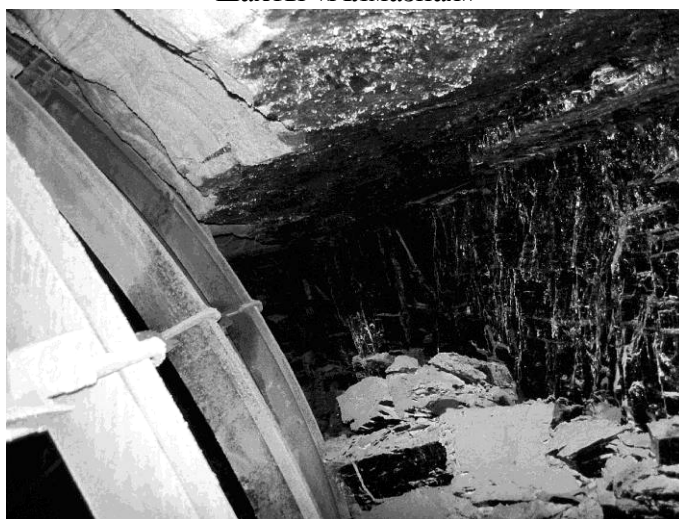
Рис. 13. Обрушение нарушенного угля под песчаником во 2-м южном конвейерном штреке шахты «Алмазная»
