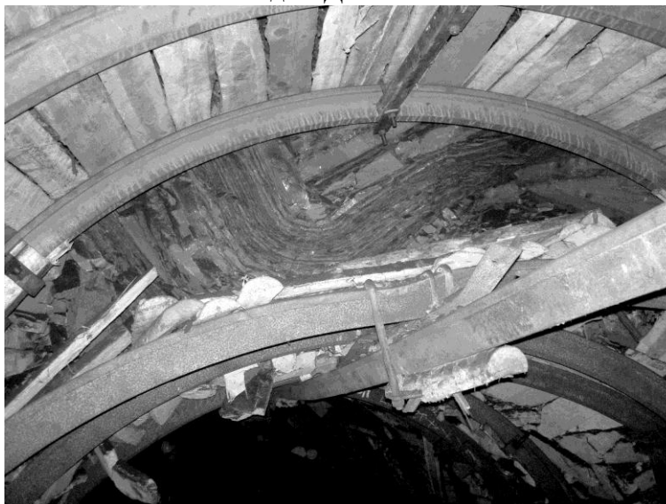
Рис. 3. Образование клина выдавливания пород кровли в условиях шахты «Свято-Андреевская»
