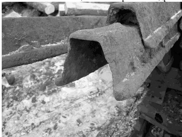
Рис. 8. Явление «самозатачивания» концов стоек арочной крепи при внедрении их в породы почвы. Шахта «Свято-Андреевская»
