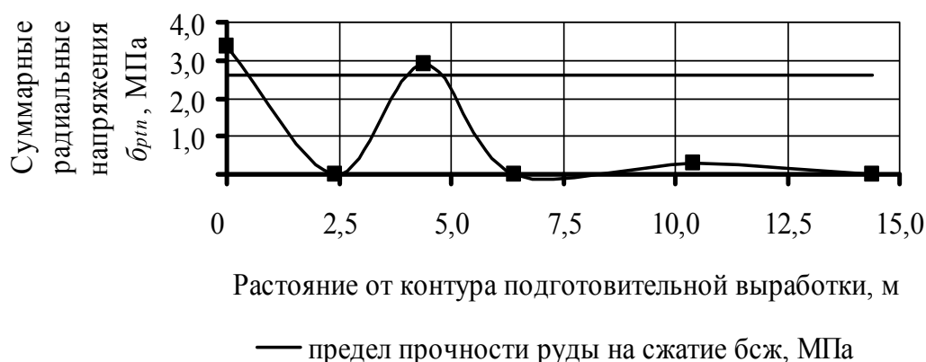
Рис. 3 Принцип формирования энергетических зон для условий проведения подготовительных выработок на глубине 1200 м в рудах прочностью 80 МПа
