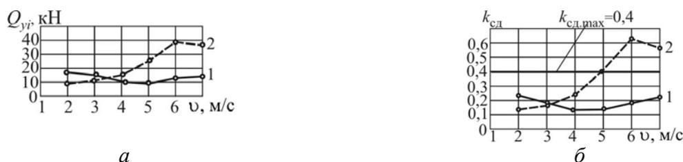
Рис. 10. Зависимости максимальных значений поперечных сил, действующих на колесные пары локомотива и коэффициентов устойчивости от сдвига пути, от скорости движения локомотива
