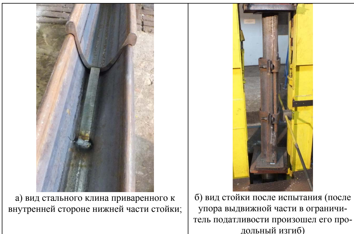
Рис. 18. Испытания стойки SV32 со стальным клином (вариант 1):
