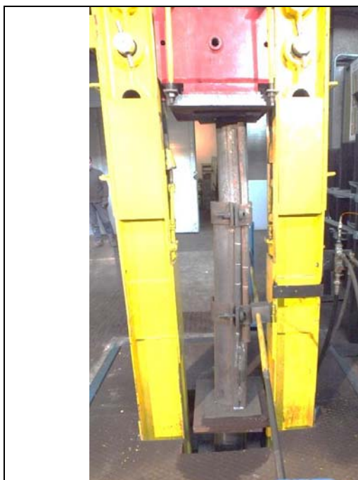
Рис. 20. Испытания стойки SV32 со стальным клином (вариант 2)
