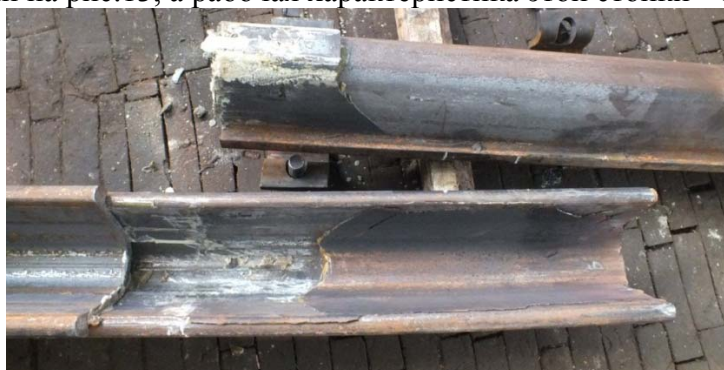
Рис. 13. Срезанный слой смолы на отрезке соединения нижней и верхней части стойки
