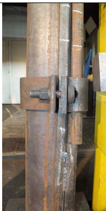
Рис. 21. Вид стойки после испытаний
