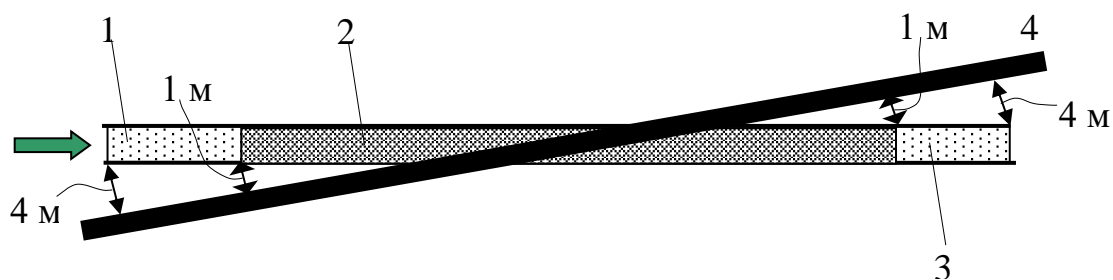
Рис. 6.10. Схема розкриття пологих вугільних пластів (за Б.Н. Кутузовим): 1 – ділянка наближення; 2 – ділянка перетину; 3 – ділянка віддалення (усі відстані рахують по нормалі до пластів); 4 – вугільний пласт
