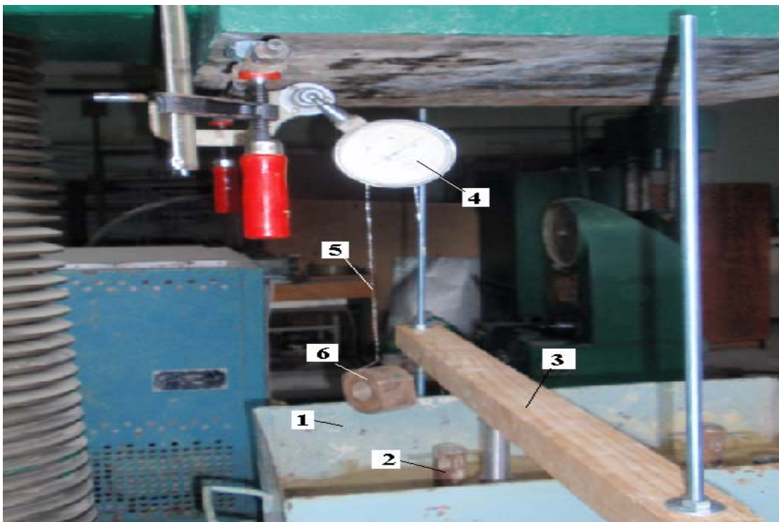
Рис. 2. Экспериментальная установка (схема) 1 - грунтовый лоток; 2 - свая; 3- загрузочное устройство; 4 - прогибомер; 5 – струна; 6 – груз
