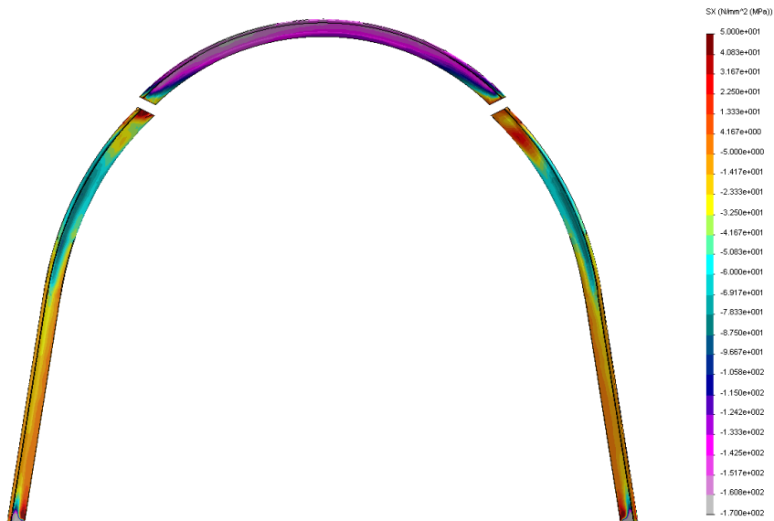
Рис. 3.7. Рамная крепь с деформационными швами в районе замков податливости: а) эпюра приведенных напряжений \sigma ; б) эпюра горизонтальных напряжений \sigma_x
