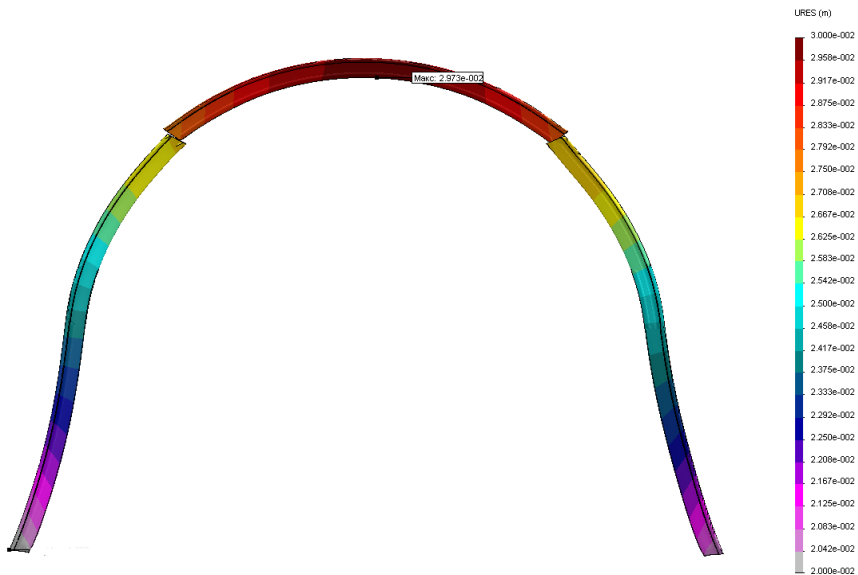
Рис. 3.8. Рамная крепь с деформационными швами в районе замков податливости: а) эпюра вертикальных напряжений \sigma_y ; б) эпюра полных перемещений U
