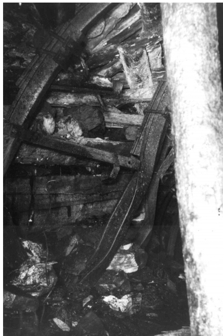
Рис. 9.6. Общий вид 553 бортового штрека позади 551 лавы на расстоянии 30-50 м, закреплен рамной крепью АП-3
