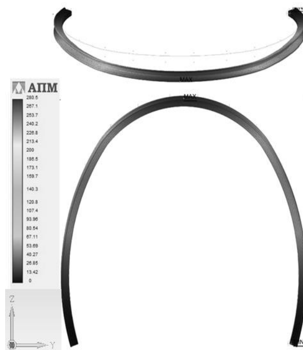
Рис. 3. Кріплення із зображенням полів переміщення
