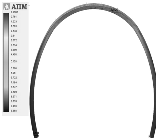
Рис. 4. Кріплення з відображенням полів коефіцієнта запасу міцності
