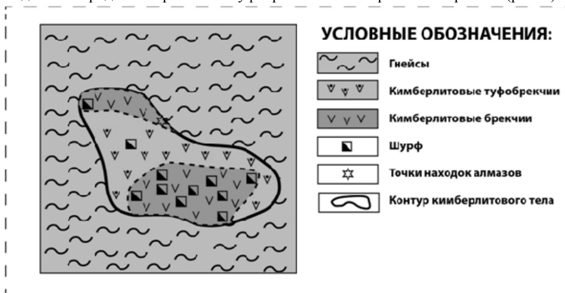
Рис. 4 Строение трубки К-1
