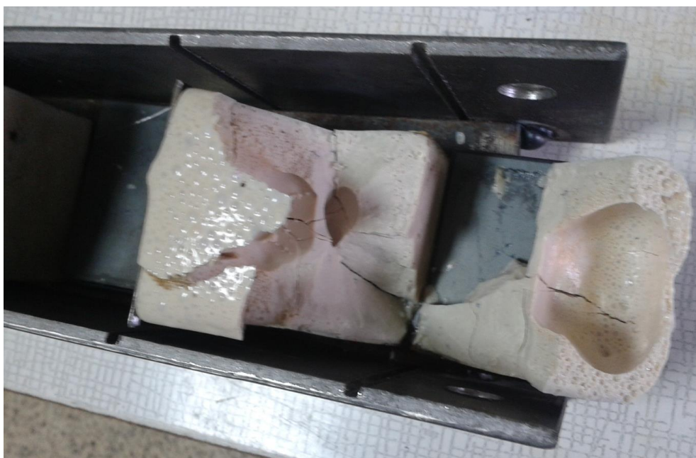
Рис. 1. Внешний вид образца ПЭТ после кристаллизации
