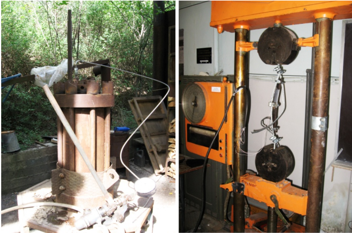
Рисунок 7 – Испытание и тарирование электроизмерительного оборудование в гидростате (а) и на механическом прессе (б)
