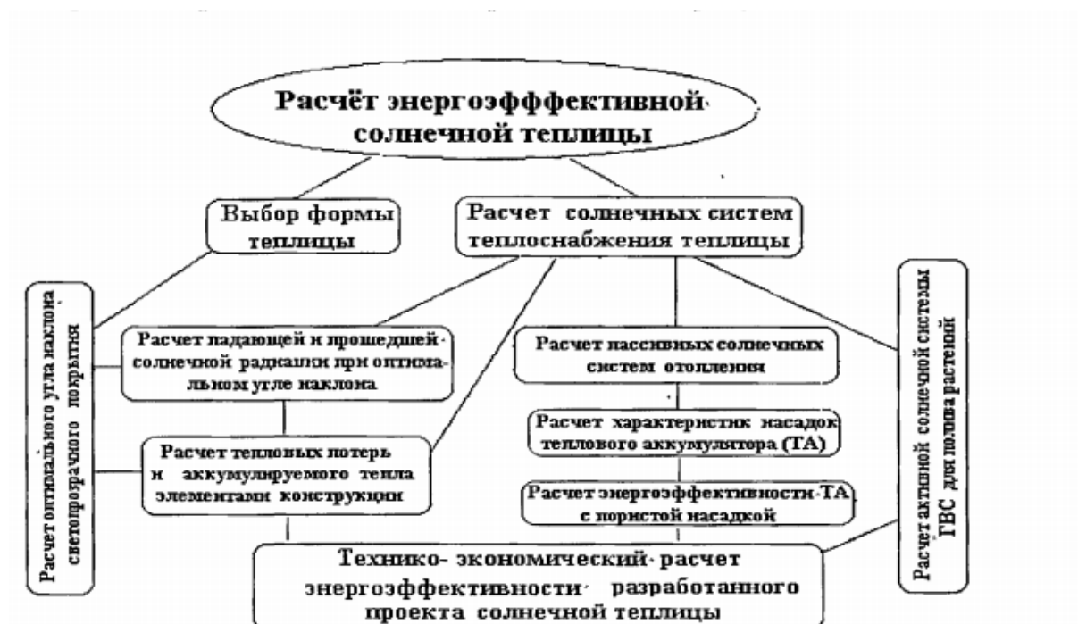
Рисунок 1. Схема алгоритма расчета энергоэффективности солнечной теплицы
