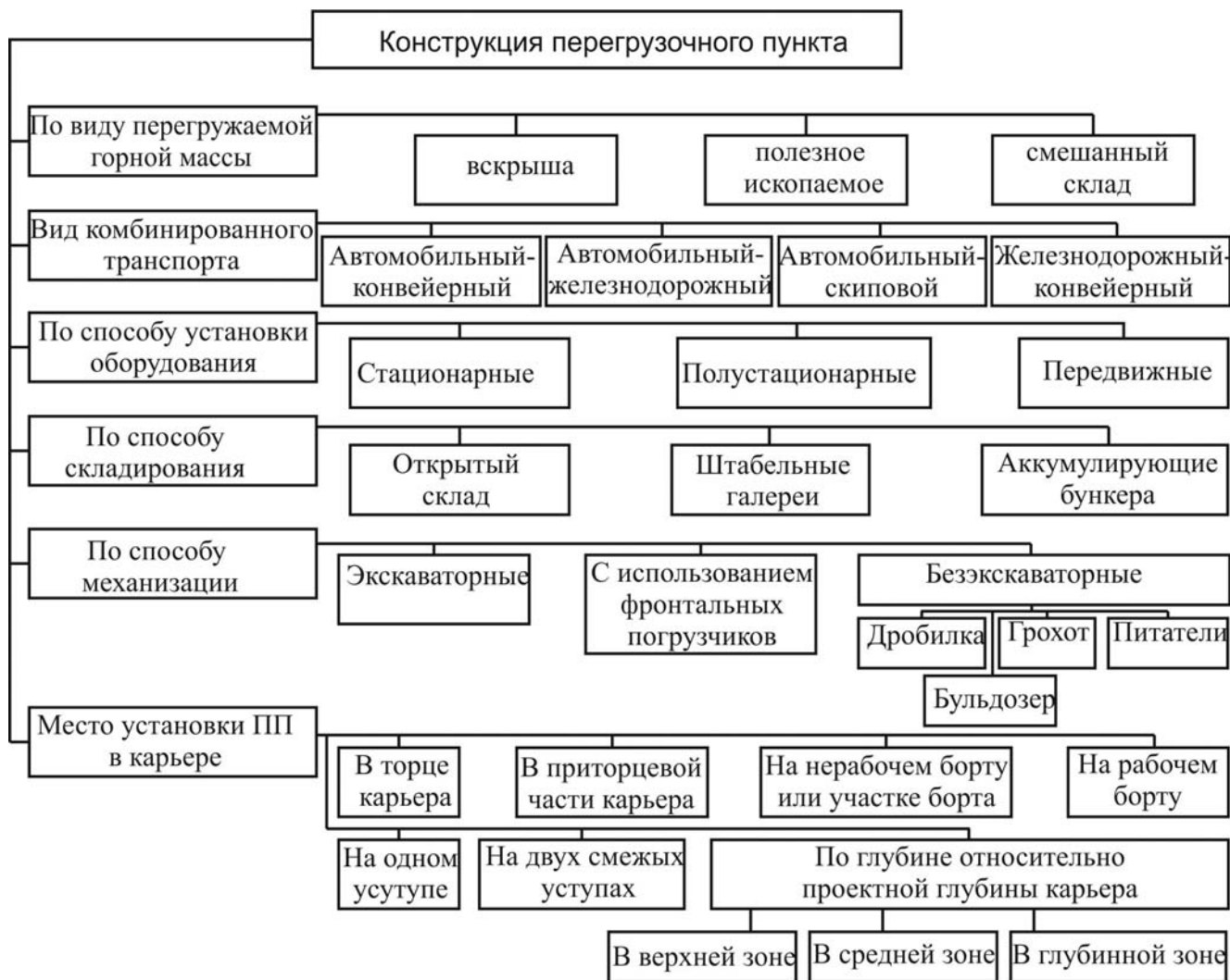
Рис. 2.29. Классификация перегрузочных пунктов, используемых при разработке глубоких карьеров
