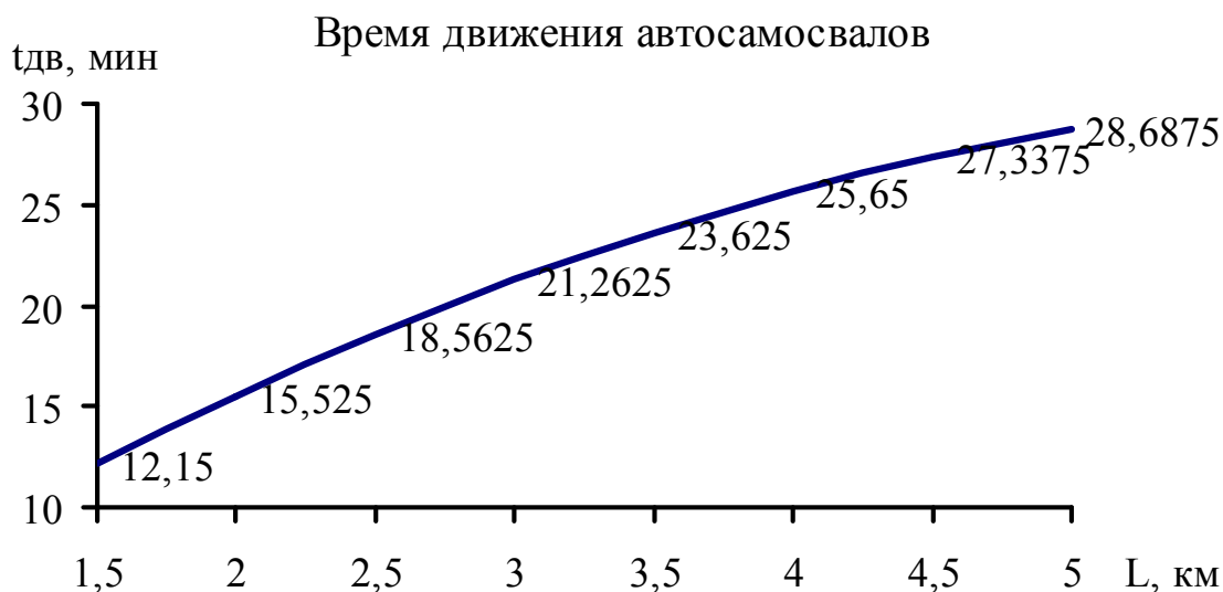
Рис. 2.24. График зависимости времени движения t_{дв} (мин) от расстояния транспортирования L (км) в глубоком карьере
