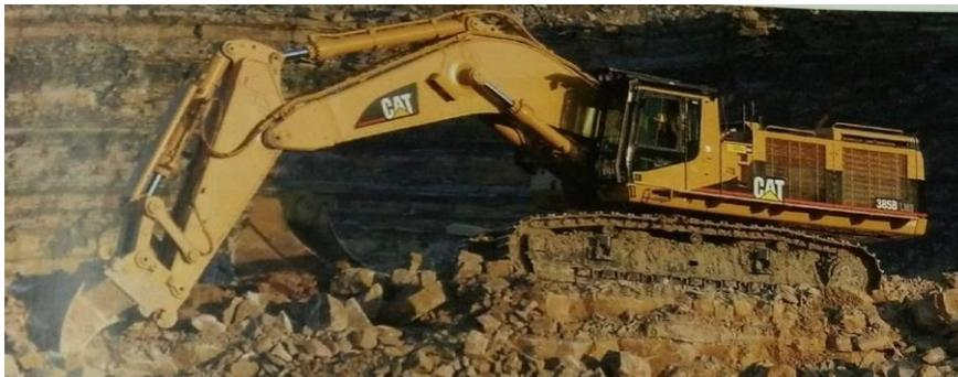
Это нужно учитывать при использовании машины и выборе технологии разработки. Послойная разработка сверху вниз ниже уровня стоянки является самым простым и чаще всего самым лучшим методом в случае горизонтальных или слабонаклонных пластов, таких как песчаник или аргиллит, а также многие сланцеватые материалы.
