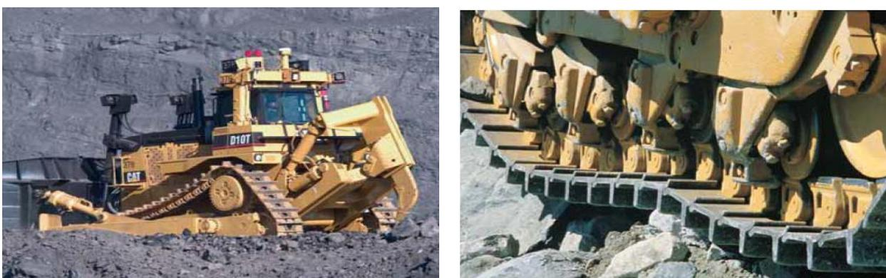
Рис.2.1 Маятниковая подвеска гусеничной тележки. Все грунтозацепы упираются в грунт
