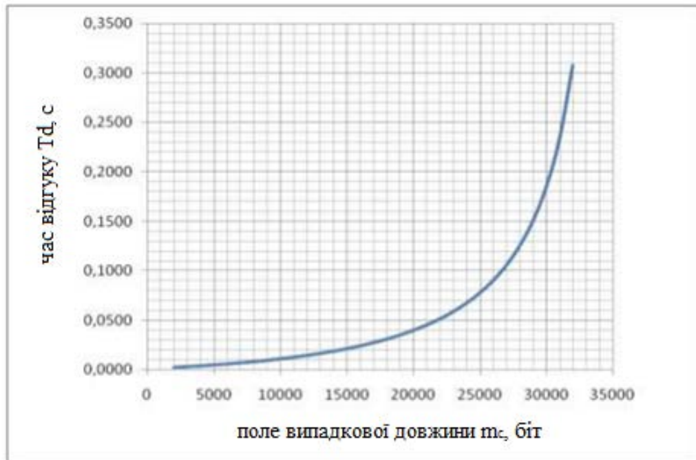
Рисунок 2.12 - Залежність часу відгуку від поля випадкової довжини
