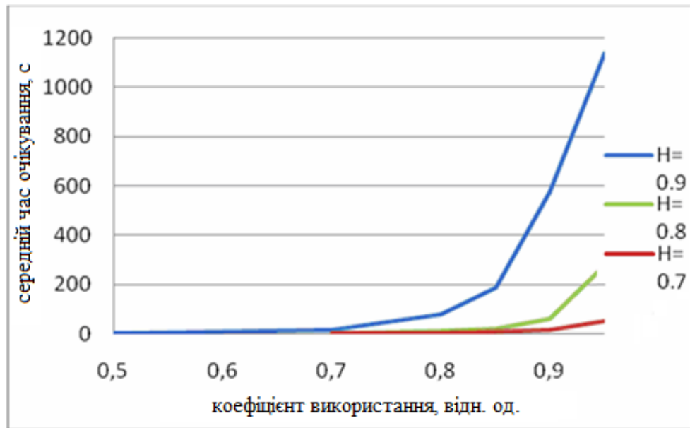
Рисунок 2.18 - Залежність часу затримки від завантаження пропускної здатності маршрутизатора самоподібним потоком
