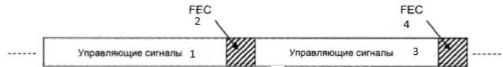
Рис 2.24 - Схема вариантов осуществления, которые применяют способы прямого исправления ошибок
