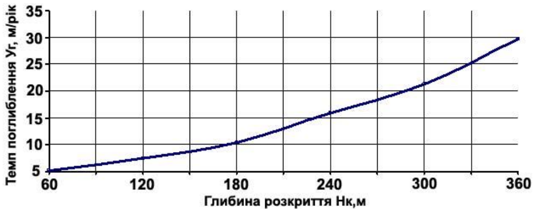
Рис. III.24. Графік залежності темпу поглиблення гірничих робіт U_g (м/рік) від глибини горизонту кар'єру H_k (м), що розкривається
