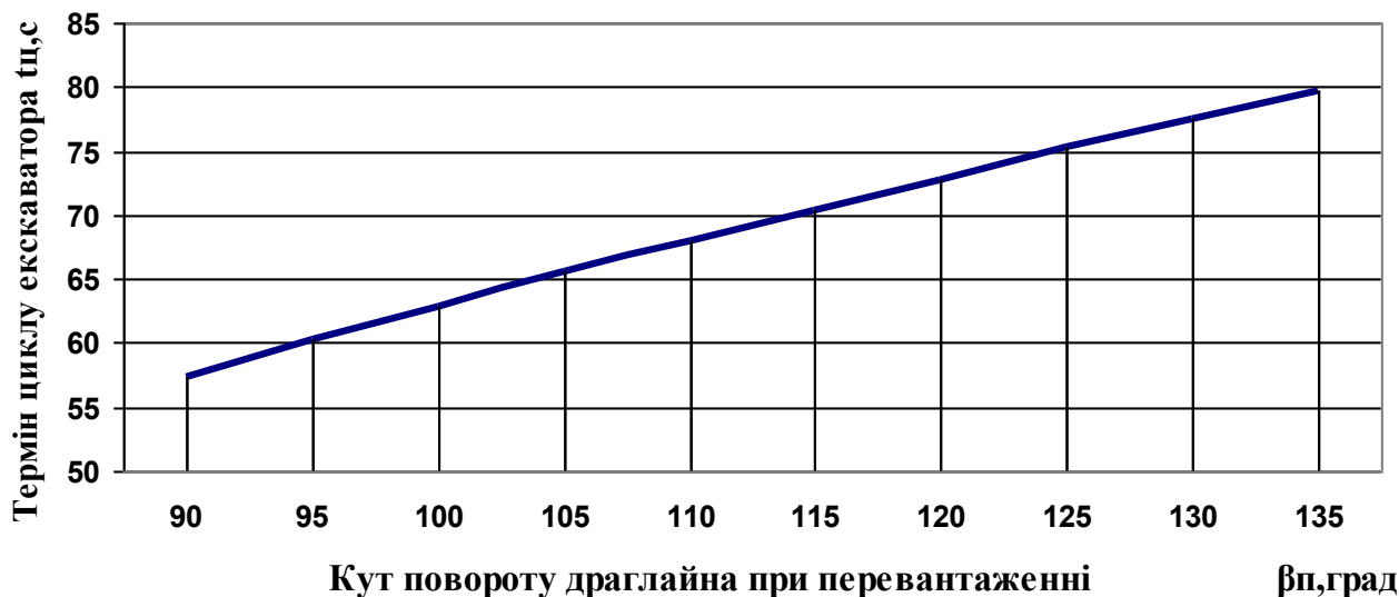
Рис. III.32. Графік залежності тривалості робочого циклу драглайну ЕШ-20/90 t_{cy} (с) від кута його повороту \beta_n (град.) при навантаженні гірничої маси до бункера-перевантажувача
