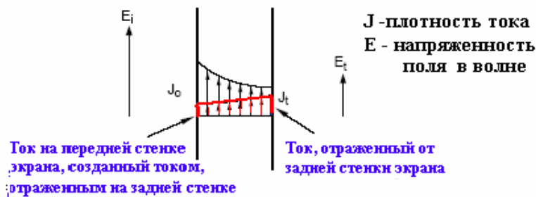
Рисунок 1.10 – Послаблення індукційного струму в екрані з тонкою стінкою
