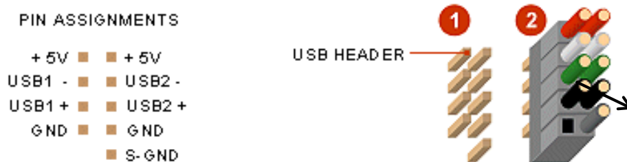
Рисунок 2.1 – Схема розпаювання контактів USB
