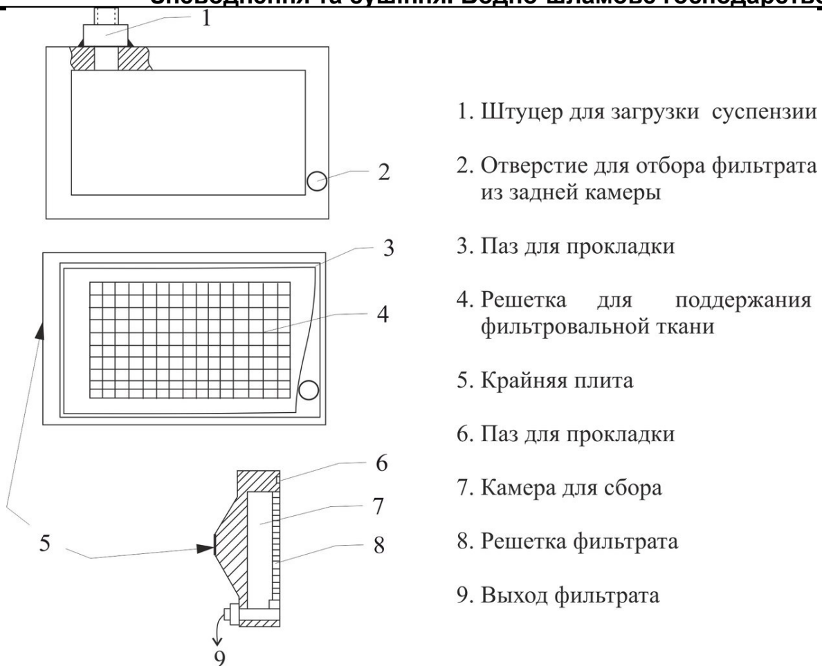
Рис. 3. Однокамерный лабораторный фильтр-пресс
