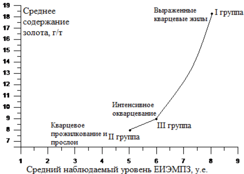
Рис. 3 График взаимосвязи уровня поля ЕИЭМПЗ (у.е.) и среднего содержания золота в скважинах (г/т) для выделенных групп пород y=0,94x+0,270; r=0,982
