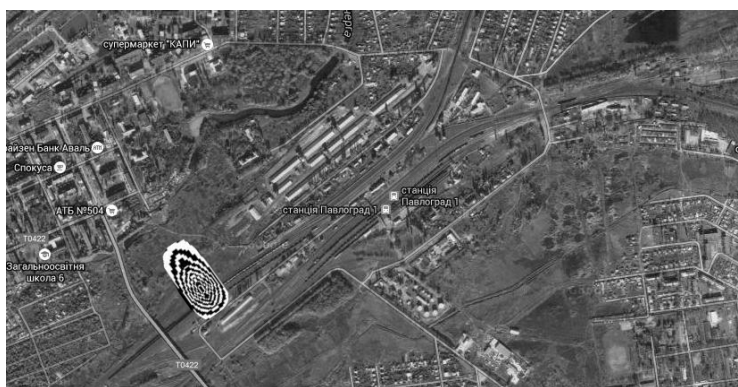
Рис.1. Зона загрязнения для момента времени t=7 мин (уровень Z=12 м)
