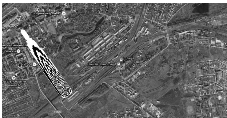
Рис.2. Зона загрязнения для момента времени t=19 мин (уровень Z=12 м)
