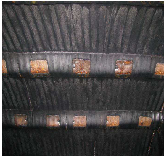
Рис. 3. Резиновая футеровка "плита – лифтер" – 8900 часов
