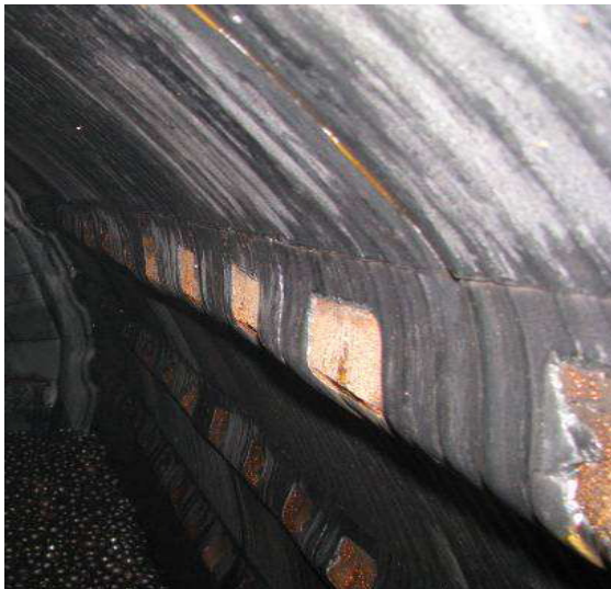
Рис. 3. Резиновая футеровка "плита – лифтер" – 8900 часов
