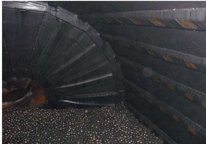
Рис. 2. Резиновая футеровка "плита – лифтер" – 1000 часов
