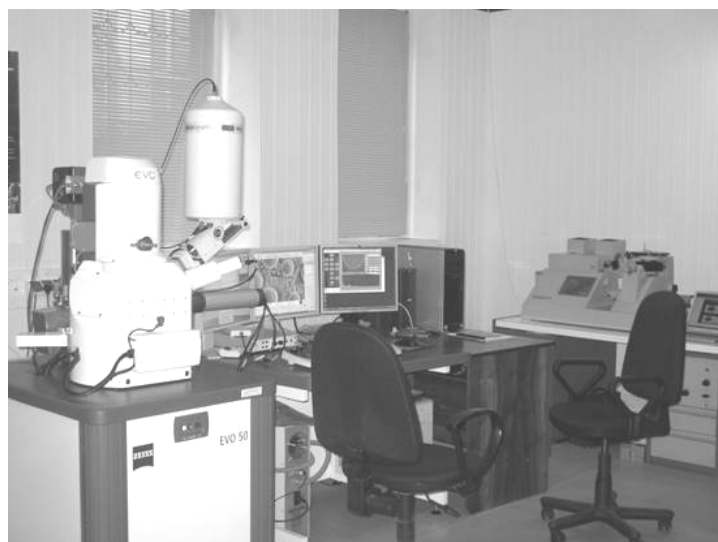
Рис. 3. Зображення мікроскопа ZEISS EVO 50XVP
