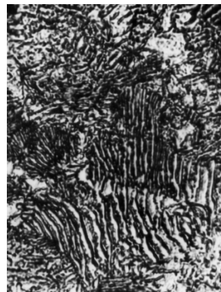
Рис.3. Сталь 55ХФА. А - горячекатаная, Б - обработка однослойным зарядом, В - обработка двуслойным зарядом. Увеличение -1000
