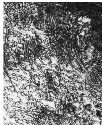
Рис.3. Сталь 55ХФА. А - горячекатаная, Б - обработка однослойным зарядом, В - обработка двуслойным зарядом. Увеличение -1000
