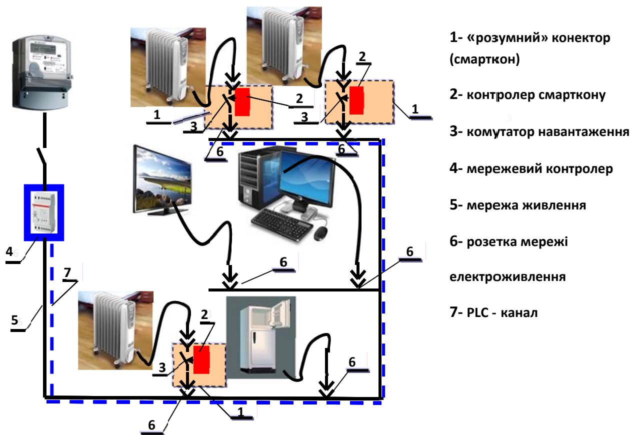
Рисунок 5.7 – Концептуальна структурна схема розумного теплого поля
