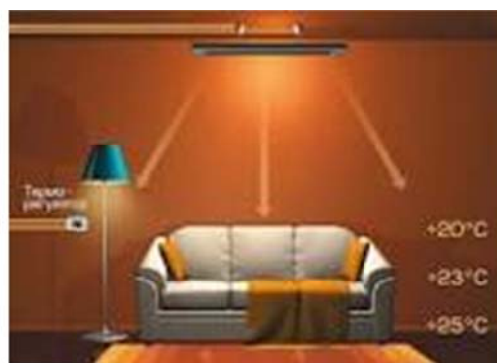
Рисунок 1.9 – Приклад зонального обігріву з використанням ІЧ – випромінювачів
