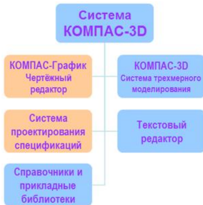
Рисунок 1. Блок-схема основних компонентів системи КОМПАС-3D
