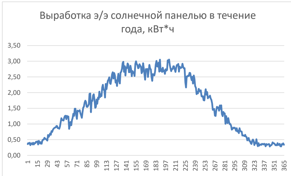
Рисунок 3.1 – Выработка электроэнергии одним фотомодулем на протяжении года
