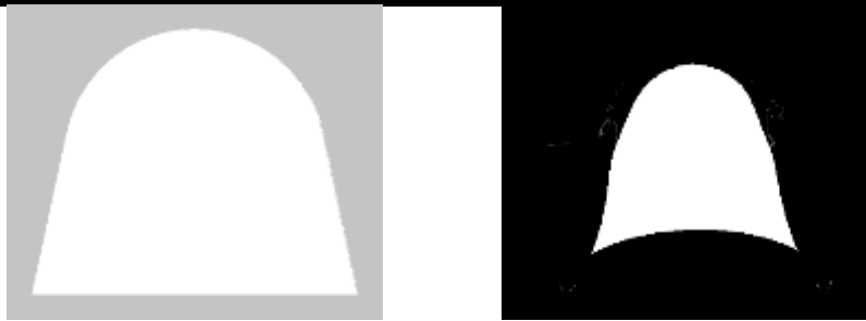
Рис. 5. Вплив кута падіння на зміну контуру виробки при взаємному прослизанні порідних шарів
