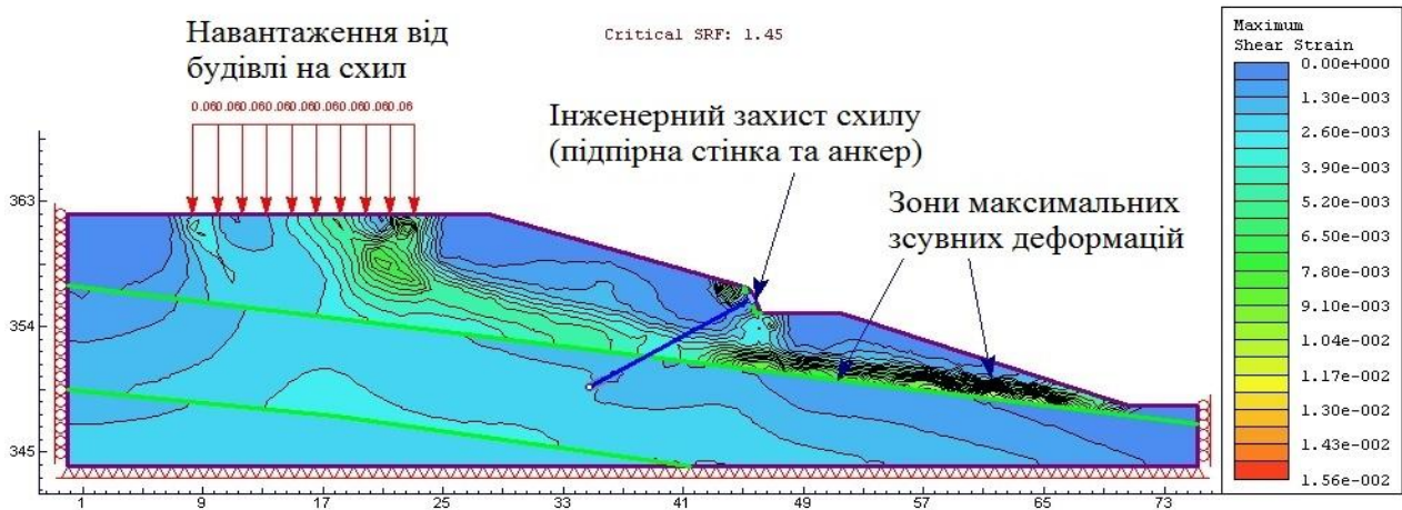
Рис. 14. Прогноз ефективності заходів інженерного захисту від зсувів
