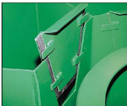
Рис. 9. Регульовані жалюзі механізму подачі для контролю розподілення потоку вібросита Derrick
