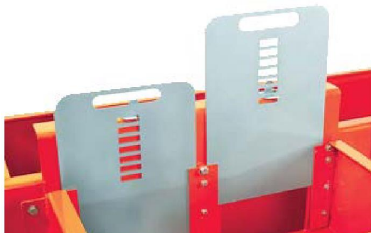
Рис. 7. Регульовані жалюзі механізму подачі для контролю розподілення потоку вібросита MONGOOSEPT
