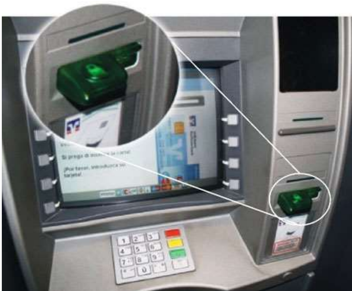
Рисунок 2.9. - Накладка на карт рідер
