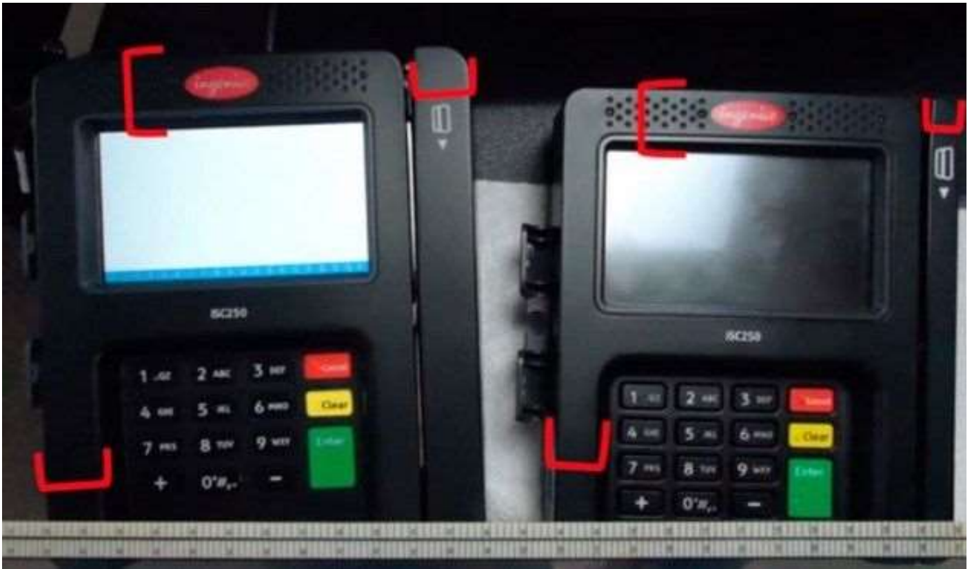
Рисунок 2.11. Оригінальний та фальшивий POS-термінали
