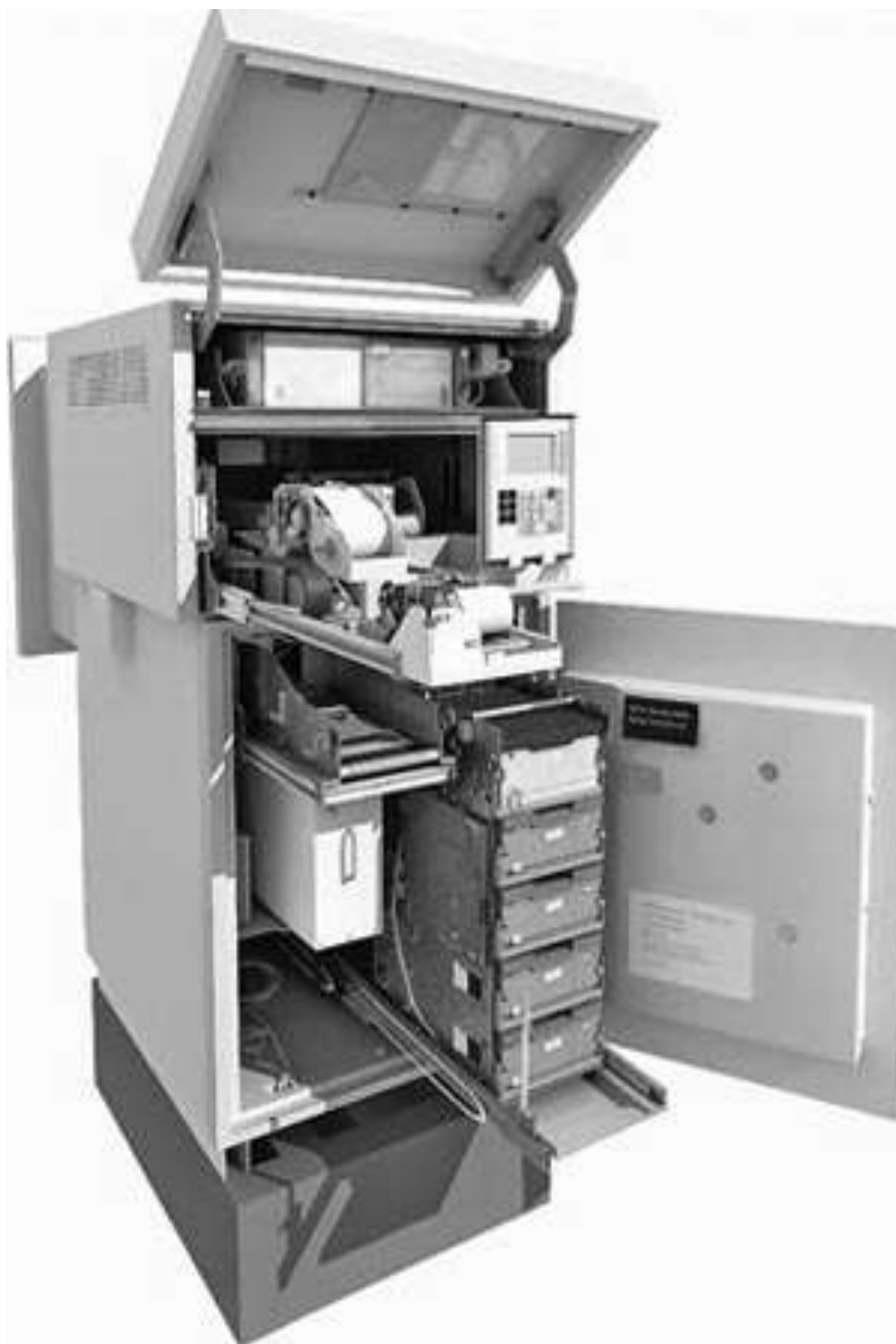
Рисунок 1.2. - Розміщення касет в банкоматах
