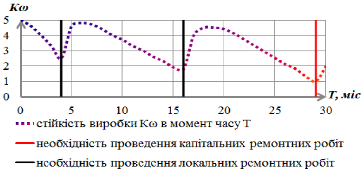
Рис. 2.9. Характер зміни показника стійкості виробки в часі
