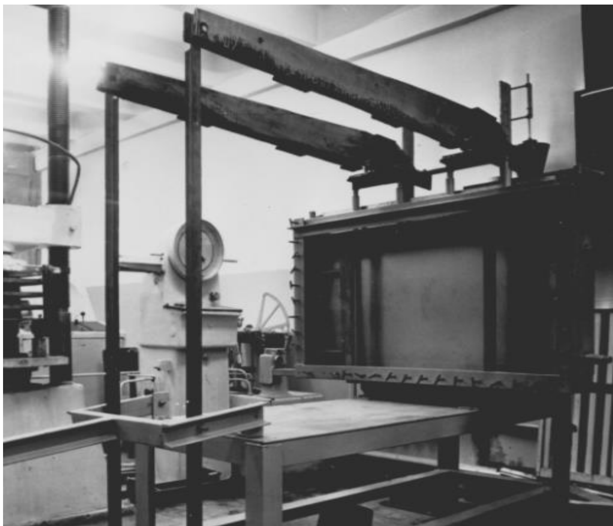
Рис. 5.1. Стенд для моделювання проявів гірського тиску на еквівалентних матеріалах
