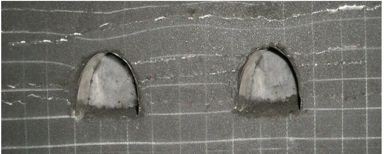
Рис. 3.6. Моделювання двох суміжних виробок (Модель В)
